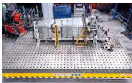
Nůžková zdvihací plošina k dispozici pro všechny standardní velikosti stolů D28
