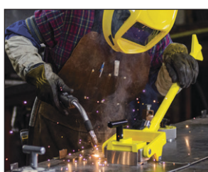
Nastavte nástroj na medzeru, zapnite magnet, stlačte pre zarovnanie. Zvárajte. Jednoduché a rýchle.
