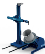
Možnosť synchronizácie C&B s pozicionérmi MOST, napr. pri výrobe zaoblených častí alebo iných prvkov.
