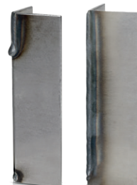
LORCH SpeedCold® pre veľmi efektívne zvarovanie tenkých prvkov.
